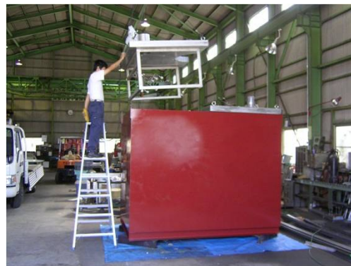
↑大型バルブの低温試験槽
