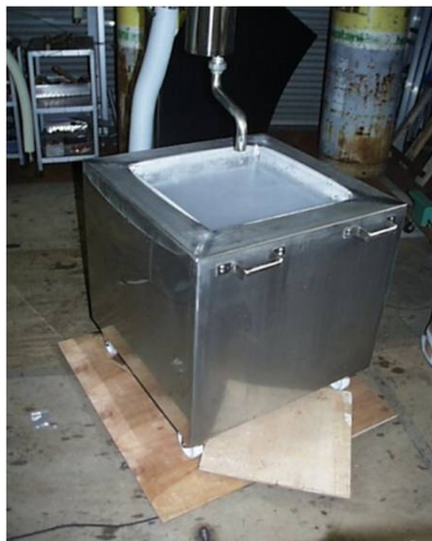
←金属冷却用浸漬槽
